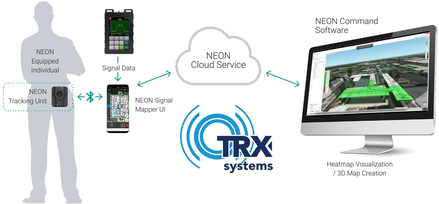
SAF-TRX集成解决方案使用NEON Signal Mapper提供实时的地理参考信号数据，这些数据既可以由用户本地显示，也可以在3D显示器上远程显示。
