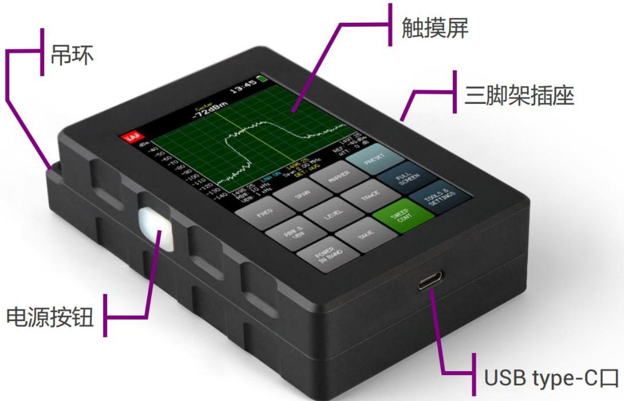
紧凑型频谱分析仪是一种超轻且易于使用的测量解决方案。这种电池供电的设备不需要外部变频器（AC-DC 电源），是任何现场工程师执行设备安装，链路故障排除，现场规划和维护的必备工具。该仪器采用电阻式触摸屏，便于现场使用，工程师在使用设备时可戴手套。此外，它的高灵敏度和低本底噪声使得即使是极其微弱的信号也能够被检测到。Spectrum Compact 还可用于高精度检测已安装路径或可用无线电信道上的现有干扰。Spectrum Compact 设备提供所有频谱扫描的数据记录，SAF Tehnika 设计的 PC 软件提供增强的数据处理和分析，该软件包含在 Spectrum Compact 的价格中。
