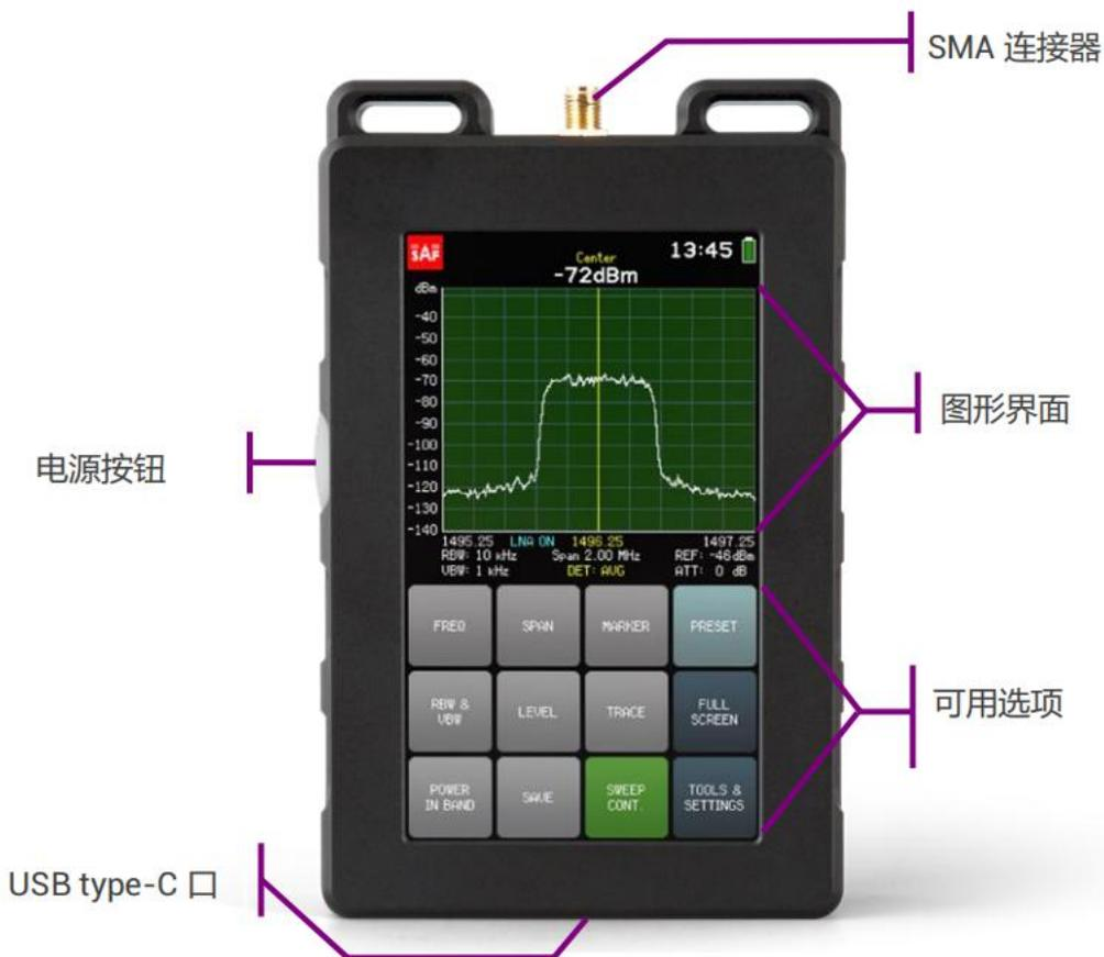
要打开 Spectrum Compact，请按住左侧的电源按钮约 1.5 秒钟。要关闭设备，请再次按住按钮约 1.5 秒钟。电池充满电后的保证运行时间为 4 小时。右上角的小电池表示当前电池电量。当剩下大约 15 分钟的有效扫描时间时，图形上方的屏幕上将显示红色警告“BATTERY LOW”。
